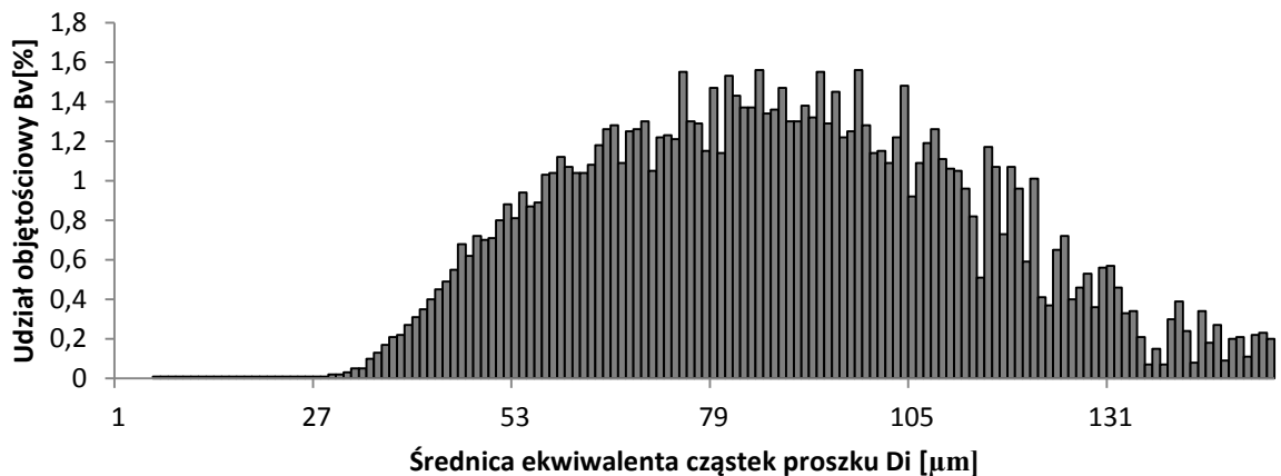
Rys. 2. Histogram rozkładu wielkości cząstek proszku MgB 2 po procesie przesiewania, wg wariantu IV
