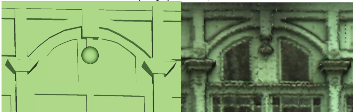
Rys. 2: Wymodelowany fragment werandy za pomocą płaszczyzn i siatki TIN (źródło: oprac. własne).
