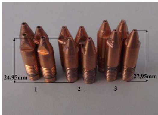
Rys.1 Zestawy dysz: 1- standardowy, 2- o zmniejszonej średnicy wylotowej, 3- o zmniejszonej średnicy wylotowej i wydłużeniu o 3mm
