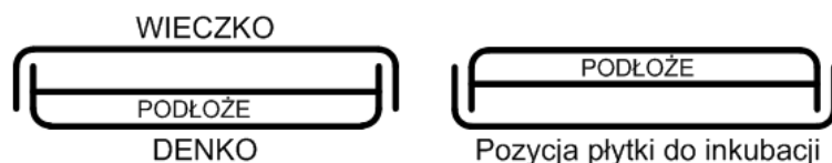
Rysunek 7 – Płytki Petriego ze stałym podłożem mikrobiologicznym, pozycja płytki po posiewie przeznaczony do inkubacji
