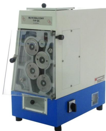
Rys. Widok laboratoryjnego młyna walcowego http://sadmiewicz.pl/files/File/mlyn4walcowy-d.jpg
