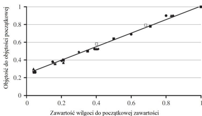
Rysunek. 2. Dane eksperymentalne skurczu kostek jabłek suszonych w różnych temperaturach powietrza i aproksymacja liniowa (równanie 5); (□) 40 °C, (■) 50 °C, (▲) 60 °C, (●) 70 °C and (◆) 80 °C.
