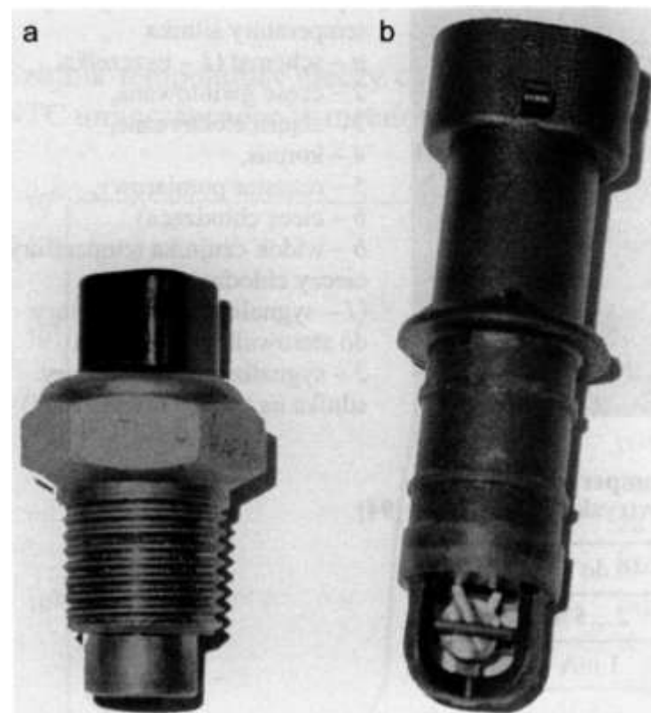
a – czujnik temperatury cieczy chłodzącej, b – czujnik temperatury powietrza zasysanego
