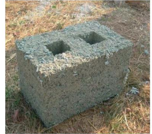
Rys. 6. Bloczek ścienny wykonany z kompozytu wapienno-konopnego [archiwum autorów]
