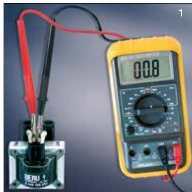
Sprawdzenie oporności pierwotnej
