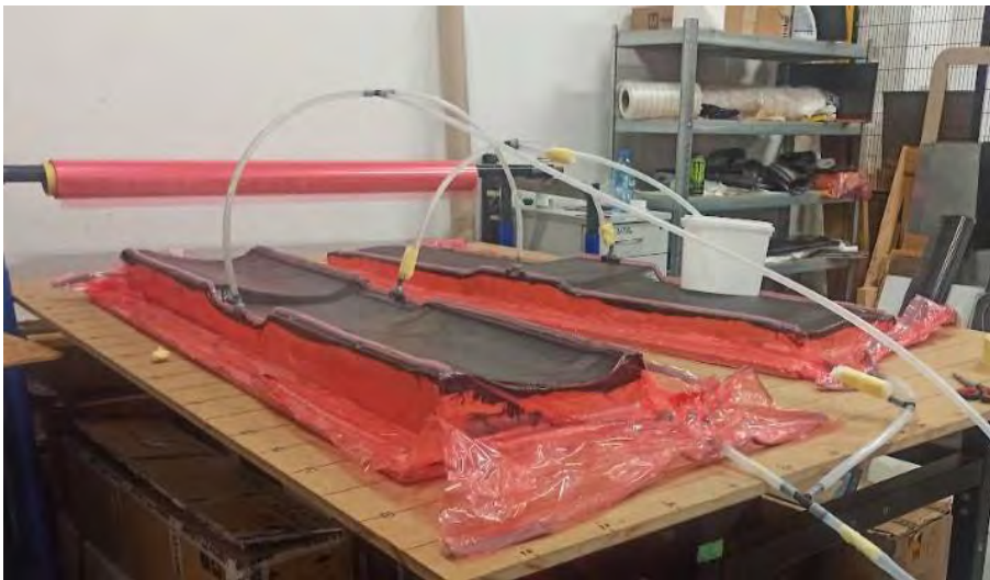
Rys. 2. Proces infuzji żywicznej płyt przedniego skrzydła pojazdu klasy Formula Student
