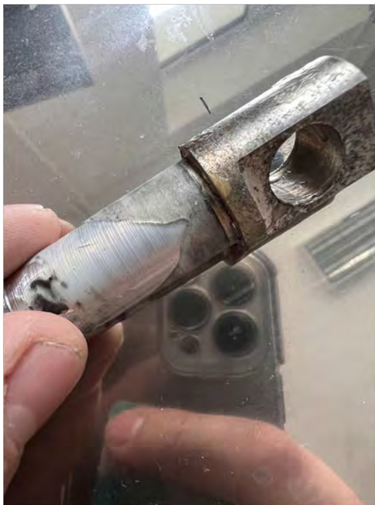
Zdjęcie 2. Insert o warstwie klejonej 0,2 mm po pierwszych testach
