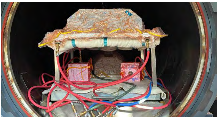
Rys. 3. Utwardzanie konstrukcji nośnej pojazdu klasy Formula Student w autoklawie
