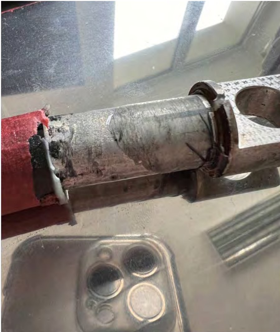
Zdjęcie 3. Insert z warstwą klejenia o grubości 0,2 mm wraz z kanalikiem
