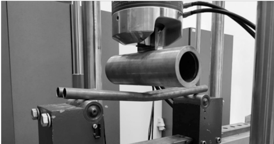
Rysunek 6. Trzy-punktowe zginanie elementu bazowego
