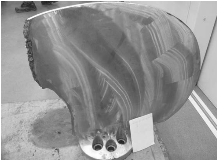
Rysunek 3. Odłamanie płatu steru strumieniowego
