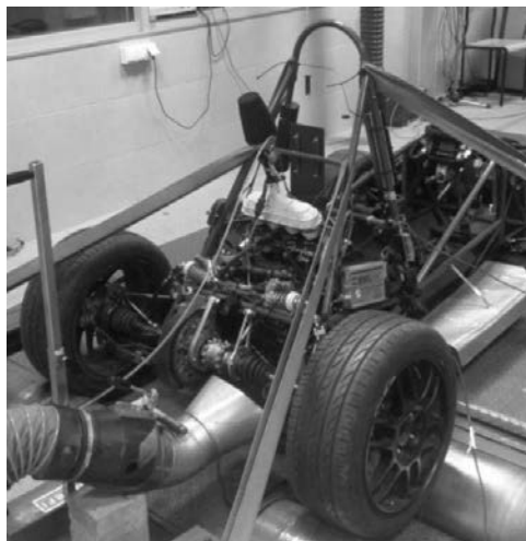
Rysunek 3. Badanie charakterystyki zewnętrznej bazowego silnika pojazdu typu Formuła Student
