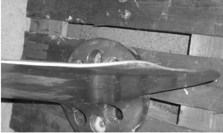
Rysunek 2. Przegięcie płatu steru strumieniowego
