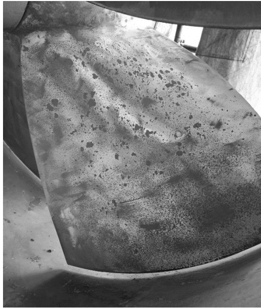
Rysunek 6. Płat śruby poddawanej regeneracji
