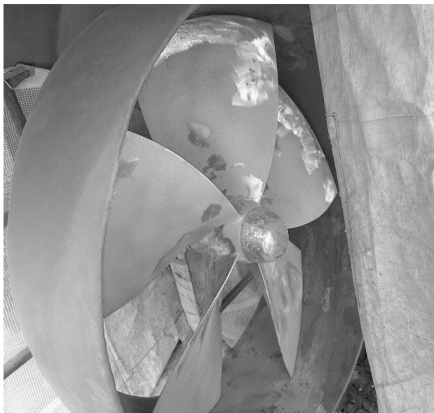
Rysunek 7. Śruba po obróbce przygotowującej do naprawy
