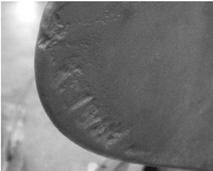
Rysunek 1. Kawitacja na płacie steru strumieniowego
