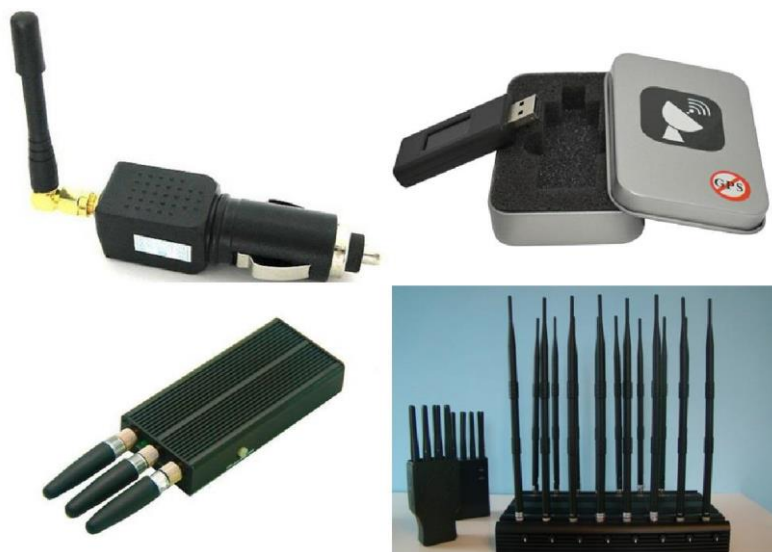
Rysunek. 1. Urządzenia nadające sygnały na częstotliwości GNSS ( Internet 1 )
