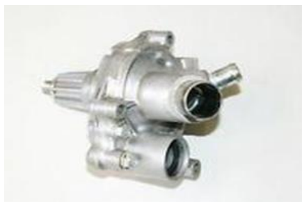
Rysunek 2. Mechaniczna pompa wody z silnika Honda CBR 600RR PC 40
