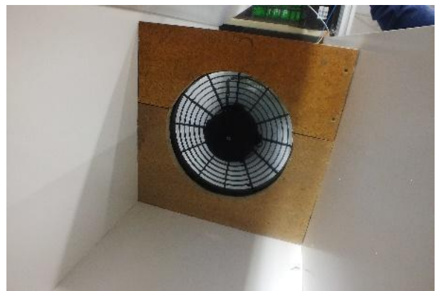
Rysunek 5. Tunel aerodynamiczny z zamontowanym wentylatorem SPAL 30100435 10
