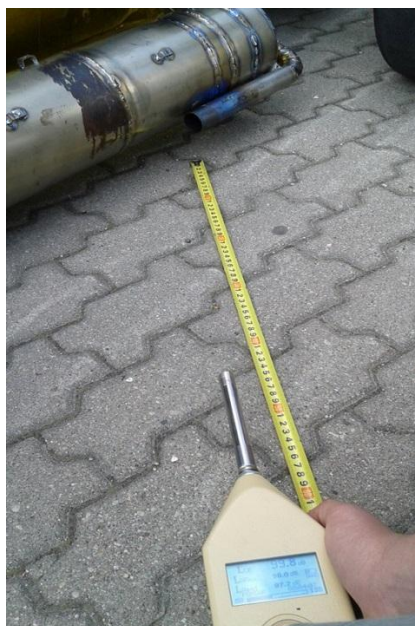
Rysunek 33. Badanie tłumika w warunkach rzeczywistych
