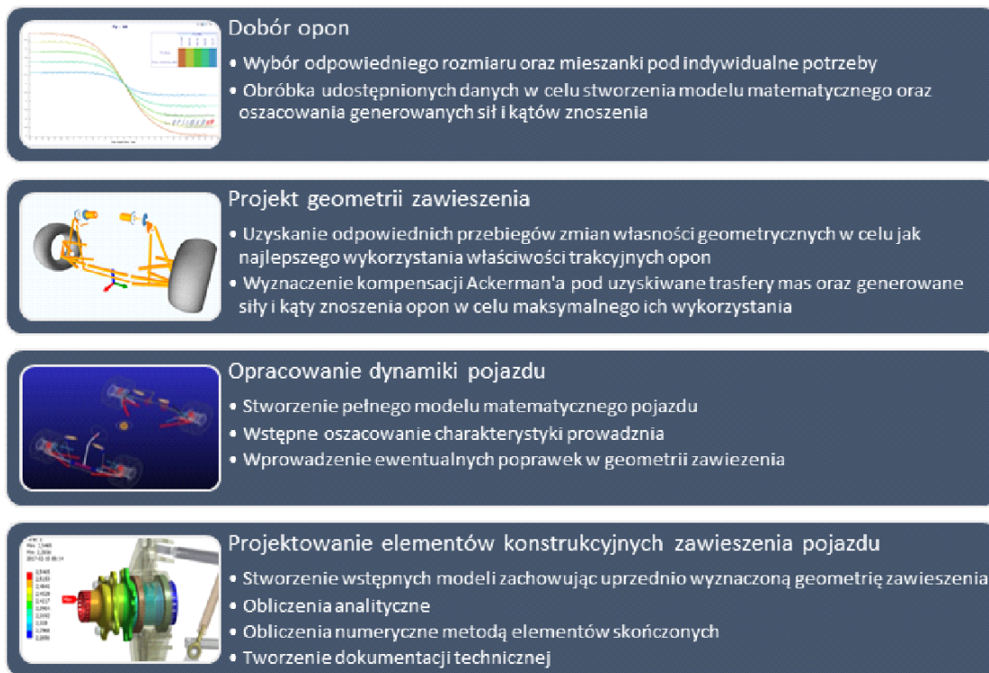
Rysunek 5. Schemat ilustrujący proces projektowania układu zawieszenia. Opracowanie własne.
