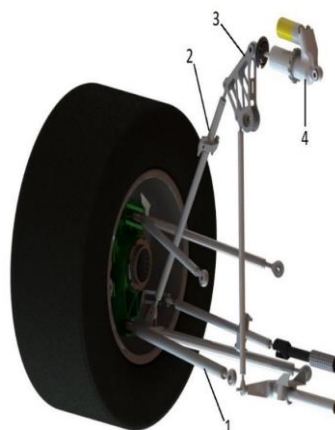
Rysunek 1. Przykład zawieszenia typu push-rod pojazdu CMS-04. (Opracowanie własne)
