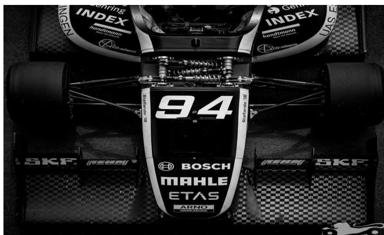
Rysunek 4. Przykład zawieszenia z wykorzystaniem trzech amortyzatorów, Rennstall Esslingen „Stallardo ‘16”. Źródło: www.rennstall-esslingen.de , 7.02.2018.
