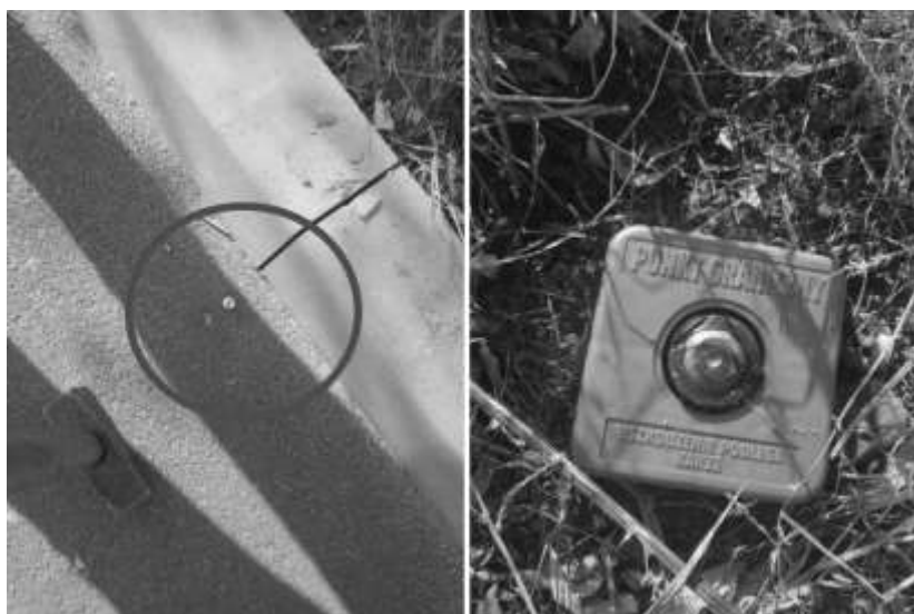
Rysunek 5 Stabilizacja punktów osnowy pomiarowej
