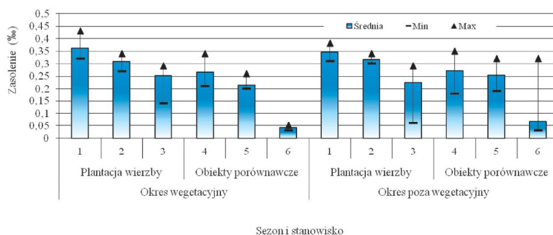
Rys. 6. Zmienność zasolenia w wodach gruntowych na plantacji wierzby i obiektach porównawczych w okresie wegetacyjnym i poza wegetacyjnym w latach 2011–2012.
