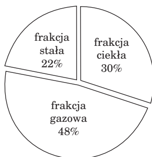
Rys. 11.3. Udział masowy produktów wolnej pirolizy wysokotemperaturowe RDF
