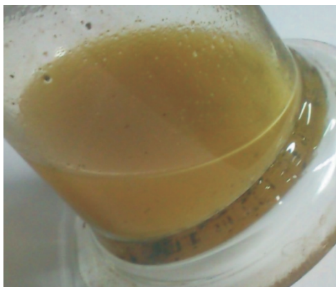
Rys. 10.11. Olej otrzymany podczas wolnej pirolizy polietylenu
