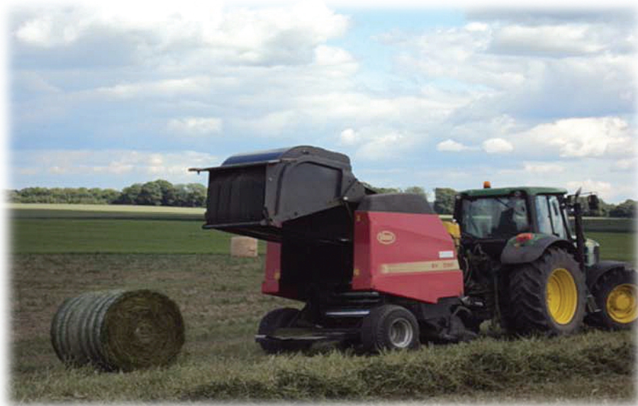
Fot. 6.4. Zbiór podsuszanej biomasy traw w bele cylindryczne (fot. A. Parzonka)
