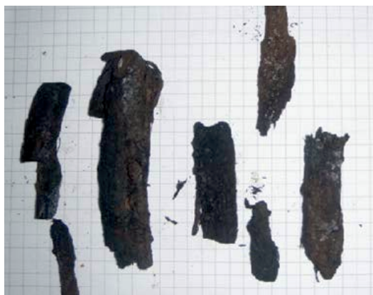
Rys. 5. Produkty stałe kwaśnej hydrolizy ślazuwca zakończonej eksplozją pary
