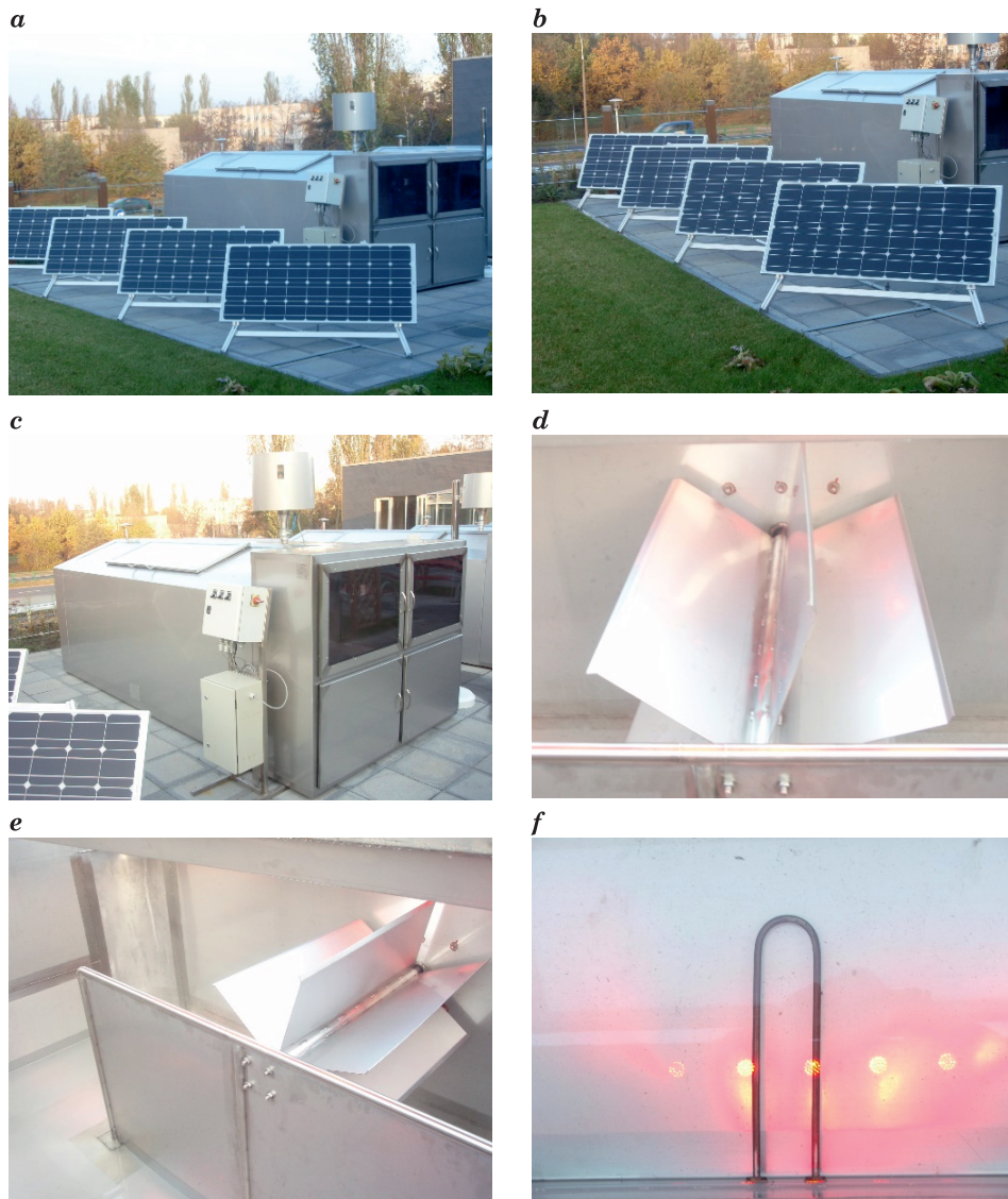
Rys. 3. Elementy fotobioreaktora ( a , b , c – reaktor wraz z systemem baterii słonecznych zasilających system oświetleniowy, d – mieszadło łopatkowe napędzane silnikiem z motoreduktorem, e – przegroda centralna oraz mieszadło łopatkowe, f – jedna z grzałek systemu stabilizacji temperatury oraz widoczne oświetlenie diodami LED)
