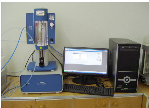
Rys. 10. Oznaczenie lepkości kinematycznej przy pomocy wiskozymetru miniAV®-X
