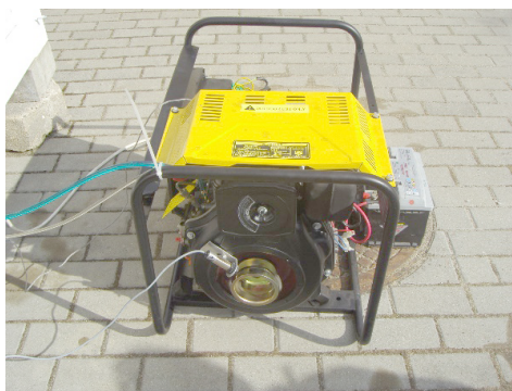
Rys. 13. Silnik zasilany B-100 na bazie oleju z glonów
