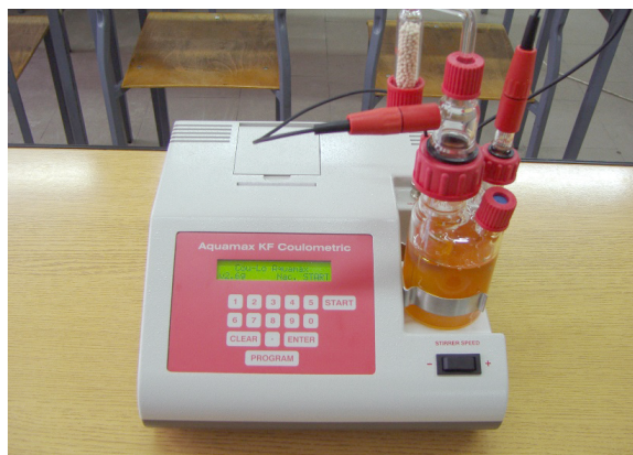
Rys. 9. Oznaczenie zawartości wody w paliwie przy pomocy analizatora Cou-Lo Aquamax KF
